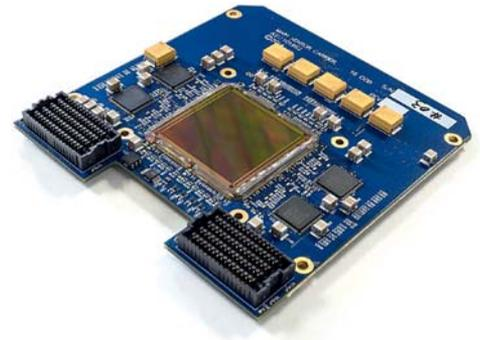
2 | Platz sparend: Durch die individuelle Fertigung können die Bildsensoren statt in einem Gehäuse auch direkt auf der zugehörigen Platine montiert werden, was Produktionskosten und Bauraum spart
