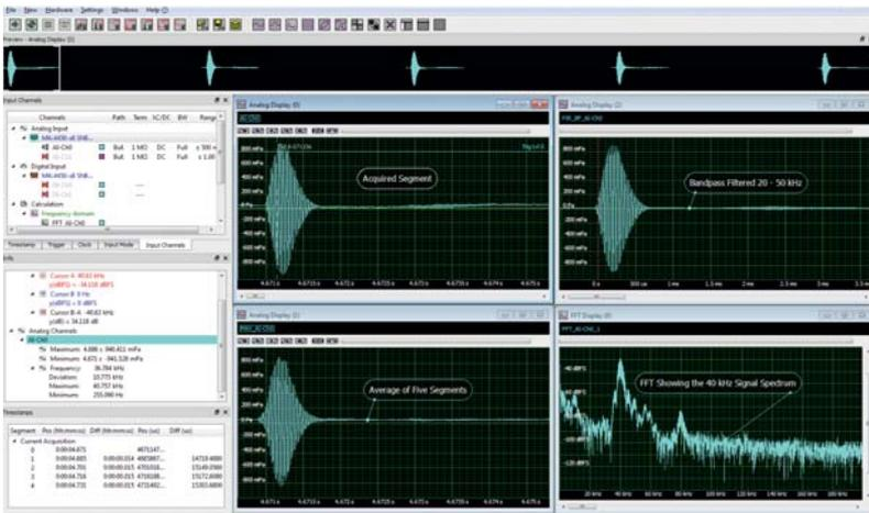
1 | Ultraschallsignal in SBench 6: Die fünf Segmente einer Mehrfachaufzeichnung werden mittels Bandpassfilter, Mittelung und FFT verarbeitet
