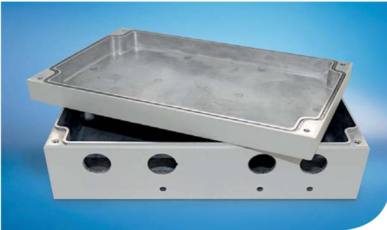
1 | Schutzart IP67: Der Deckel des Gehäuses aus Aluminiumdruckguss ist mit einer Dichtung aus Polyurethan versehen und schützt damit die verbaute Elektronik vor Spritzwasser
