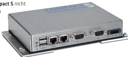
Trotz der geringen Abmessungen ermöglichen die Industriecomputer vielseitige Anbindung. Sie verfügen über CAN-, USB-, RS232- sowie RS485-Schnittstellen, lassen sich mit bis zu drei Ethernet-Schnittstellen ausstatten und sind mit WLAN-, GPS-, GSM und Bluetooth-Modulen erweiterbar. Sie sind in einem 169x33,5x127 mm<sup>3</sup>-großen Gehäuse der Schutzklasse IP40 untergebracht, kommen ohne bewegliche Teile aus und eignen sich für den Dauerbetrieb bei Temperaturen von -40 bis +70 °C.
