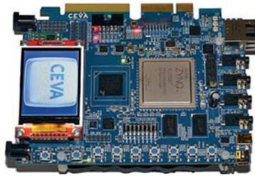
Die Entwicklungsplattform basiert auf einem Strom sparenden DSP und Subsystem TeakLite-4, gefertigt bei SMIC in deren 55-nm-LP-Prozess
