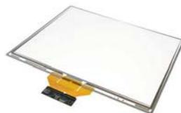
Von Industrie-OEMs auf Tauglichkeit untersucht: PressScreen mit eigens entwickelter Drucksensorik
