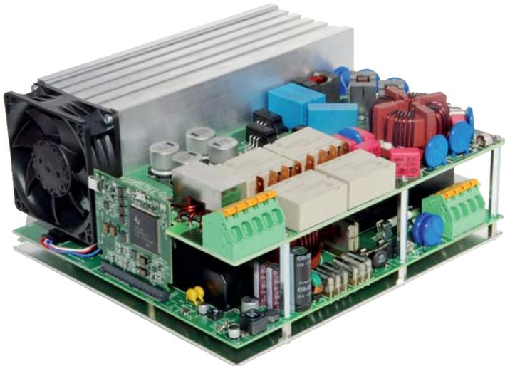
Dreiphasiger 10-kW-USV-Wechselrichter mit einem Volumen von 5l und 98,7% Wirkungsgrad
