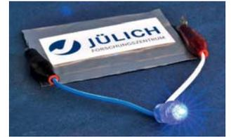
Festkörperbatterie mit einer Kathode aus Lithium-Kobalt-Oxid, einer Anode aus Lithiummetall und teilsubstituiertem Lithium-Lanthan-Zirkonat als Elektrolyt
