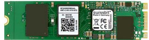
X-60m2-Serie: SATA-SSDs im M.2-Format mit 6 GBit/s Datenrate und 1TByte Speicherkapazität
