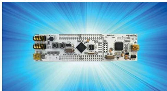
Zur Unterstützung bei der Entwicklung wird ein Evaluierungskit für die Cortex-M4F-MCU angeboten
