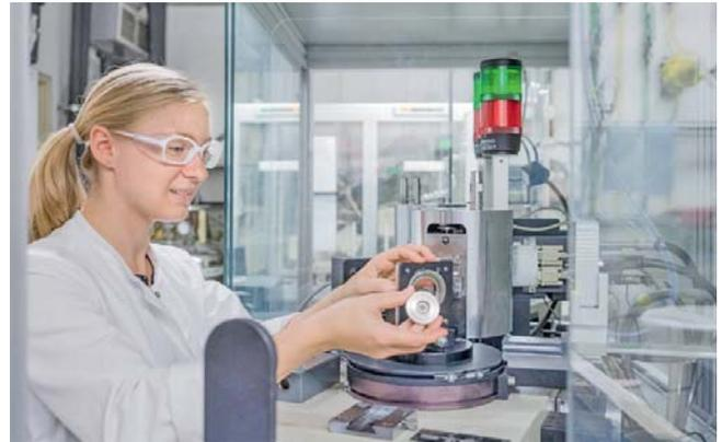
Daniela Pfister bei Messungen am Röntgendiffraktometer
