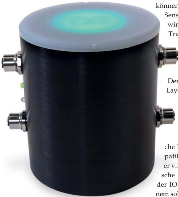
5 | Viermal M12: Das MAXREFDES79# ist das erste IO-Link-Referenzdesign für den Anschluss von bis zu vier IO-Link-Sensoren
