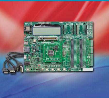
Das Explorer-16/32-Kit DM240001-3 ist eine vielseitige und sofort einsatzfähige Demo- und Testplattform für 16-Bit-PIC24- und 32-Bit-PIC32-MCUs sowie für dsPIC-DSCs. Es besteht aus dem Explorer-16/32-Entwicklungsboard für 16- und 32-Bit-PIC-Mikrocontroller sowie einem PIC24FJ1024GB610-Plug-in-Modul (PIM MA240023) und zwei USB-Kabeln.
