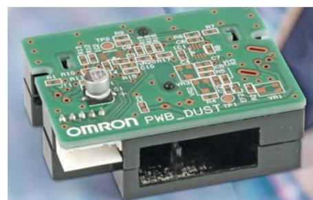
Staubsensormodul mit sechsfach höherem Luftdurchsatz als ihn andere verfügbare LED-Staubsensoren erreichen
