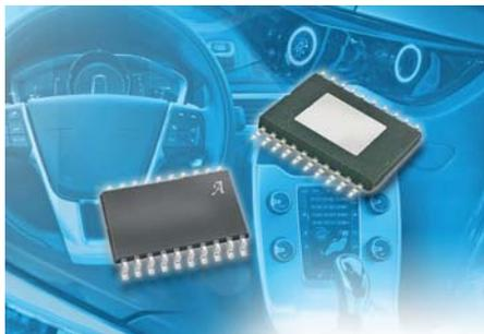
Die Bausteine enthalten einen PWM-Dimm-Schaltkreis, der über externe Widerstände eingestellt wird, um genau geregelte PWM-Tastgrade und Frequenzen zu erzielen
