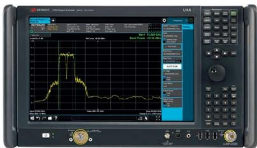
Der Signalanalysator besitzt einen 2,4-mm-Eingang für Frequenzen bis 50 GHz und einen 1,0-mm-Eingang für 110 GHz
