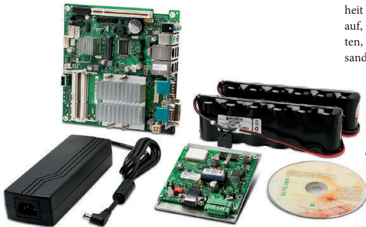
Bild 2: PC-System mit DC-USV für den medizinischen Bereich auf Basis einer Tischnetzteil-Stromversorgung. Die DC-USV stellt den unterbrechungsfreien Betrieb in der Patientenumgebung sicher.
