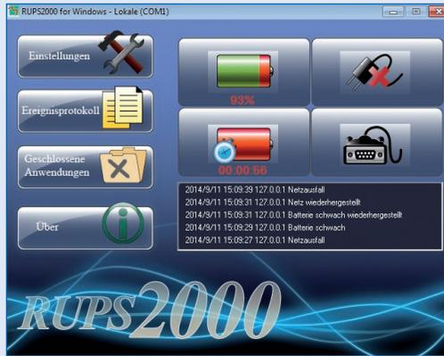
Netzstecker ziehen = Netzausfall simulieren. Der PC fährt nach vorgegebener Zeit herunter und schaltet ab.
