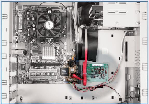
Platine in das Gehäuse einbauen.
